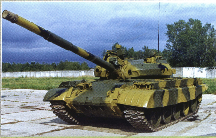
Танк Т-62М, общий вид. Хорошо видно крепление дополнительной брони на башне машины.
